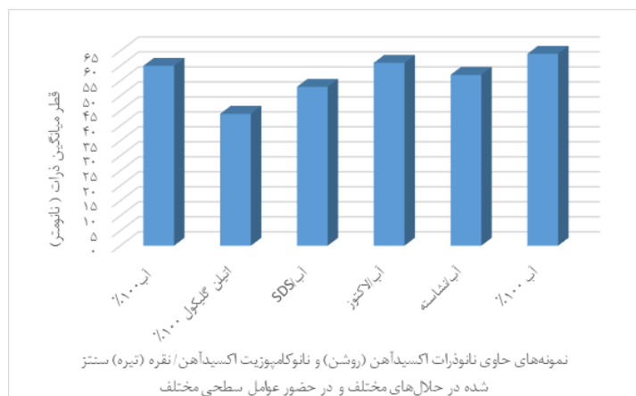
شکل ۱۰: مقایسه قطر میانگین بدست آمده توسط نرم‌افزار Motic برای نانوذرات \text{Fe}_3\text{O}_4/\text{Ag} سنتز شده در شرایط مختلف و نانوذرات کامپوزیت
