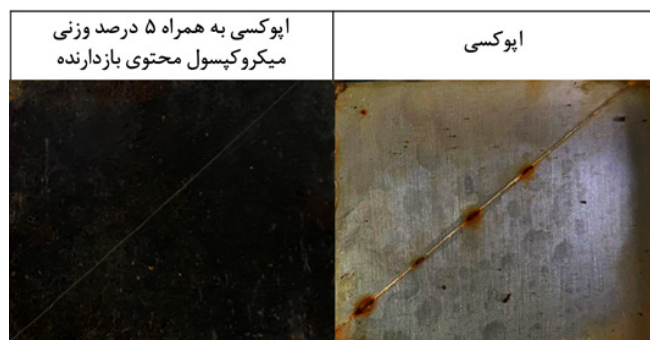
شکل ۱۰: تصویر دیجیتال نمونه‌های پوششی اپوکسی در حضور و عدم حضور میکروکپسول محتوی بازدارنده 8-HQ بعد از ۴ هفته قرارگیری در کابین مه نمکی
