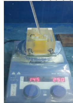
شکل ۱: کادمیوم سولفید سنتز شده داخل ظرف محتوی پیش‌ماده‌ها به همراه هیتر مورد استفاده.
