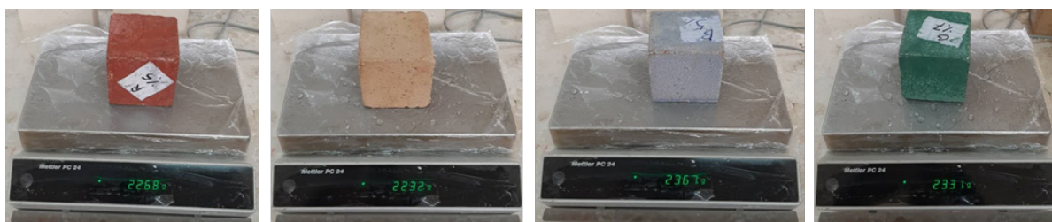
شکل ۵: وزن گیری نمونه‌های بتن رنگی جهت تعیین میزان جذب آب در بتن سخت شده
