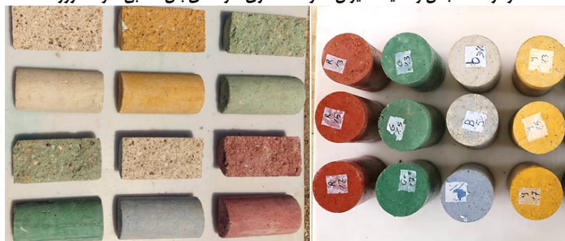
شکل ۴: سنجش مقاومت کششی نمونه های استوانه ای دارای رنگدانه های رنگی
