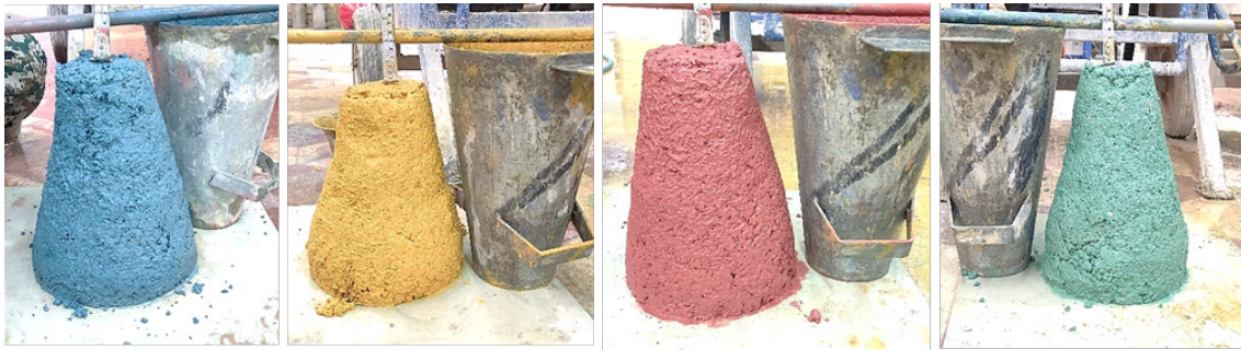
شکل ۲: اسلامپ طرح مخلوط‌های آزمایش شده
