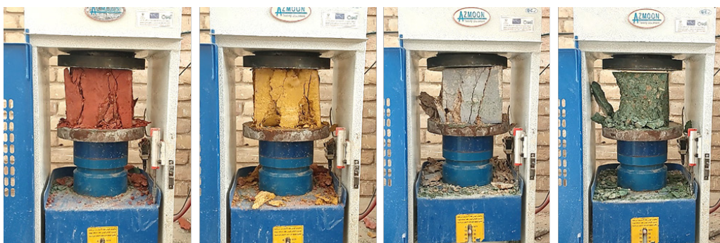
شکل ۳: آزمایش مقاومت فشاری نمونه‌های بتن مکعبی ۷ و ۲۸ روزه بتن‌های رنگی
