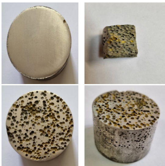
شکل ۳. مورفولوژی فوم منیزیم سه لایه درجه بندی شده تولید شده
