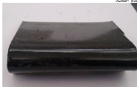
شکل ۳) نمونه شماره ۴ بعد از آزمون خمش توسط میله با قطر ۲ میلیمتر
