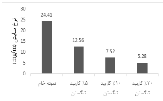
شکل ۸) نرخ سایش در نمونه‌ی خام و تأثیر افزایش مقدار ذرات تقویت‌کننده‌ی کاربید تنگستن بر نرخ سایش.
