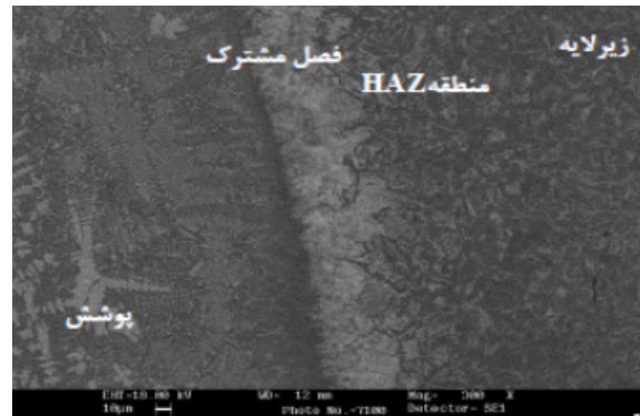
شکل ۵) تصویر SEM ریزساختار منطقه‌ی پوشش، فصل مشترک، HAZ و زیر لایه.
