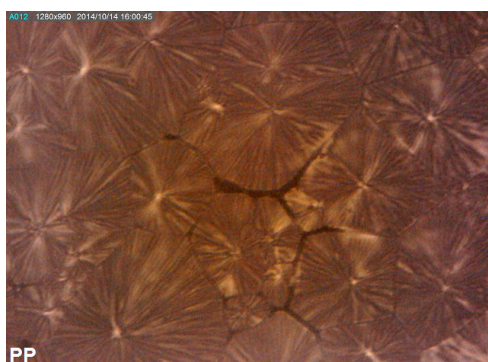
شکل ۷: تصاویر گویچه‌های تشکیل شده در الیاف PP خالص و الیاف نانوکامپوزیت PP/G-0.5 در شرایط یکسان
