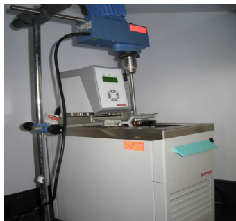
شکل ۳: تصویر فرآیند پلیمریزاسیون پلی آنیلین با روش اکسایش شیمیایی
