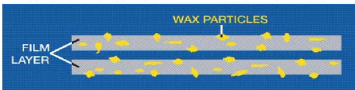
شکل ۶: پخش ذرات افزودنی وکس در کل بستر رنگ [۱۵]
