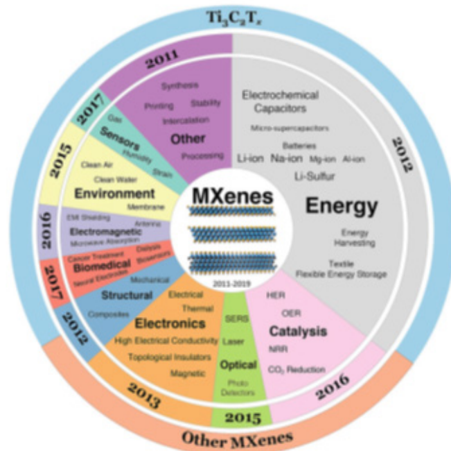
شکل ۲. شماتیک خواص مکسن‌ها (رسانایی، انعطاف مکانیکی، آب دوستی، پایداری حرارتی) و کاربردها (ذخیره انرژی، حسگرها، محافظ الکترومغناطیسی، تشخیص زیستی) را نشان می‌دهد [۱۳].
