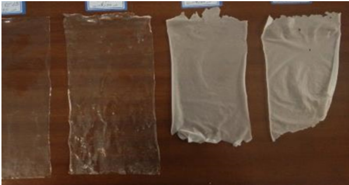
شکل ۹) نمونه‌های ساخته شده با درصدهای ۵٪، ۱۰٪، ۲۰٪ و ۳۰٪ آبشیشه (به ترتیب از چپ به راست)
