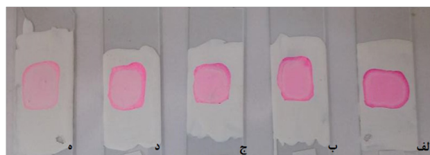
شکل ۱۰: تصویر رنگ حاوی نانوذره TiO_2/Ag ۲٪ در زیر نور مرئی ۱۰۰ وات هالوژن با غلظت Rh.B ۱۰۰ mg/L روی سطح رنگ (الف) قبل از قرارگیری در معرض نور (ب) مدت ۲ ساعت در معرض نور (ج) مدت ۴ ساعت در معرض نور (د) مدت ۶ ساعت در معرض نور (ه) مدت ۸ ساعت در معرض نور
