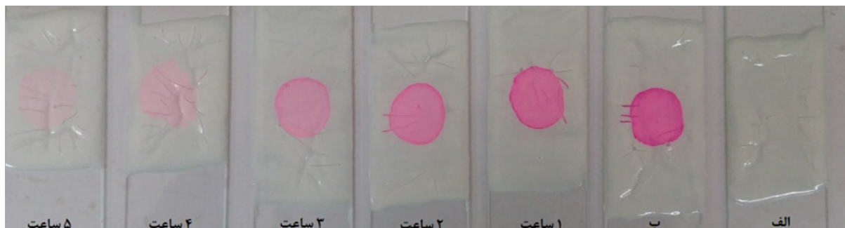
شکل ۱۲: تصاویر گرفته شده از قرارگیری رزین های آکرلیک خالص R83 زیر نور مرئی ۱۰۰ وات هالوژنی در فاصله ۱۵ سانتی متری (الف) بدون آلاینده (ب) ۱۰۰ mg/L Rh.B بدون تأثیر نور و در بقیه ساعت های قرارگیری در معرض نور
