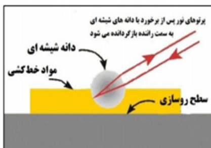
شکل ۱: چگونگی عملکرد دانه‌های شیشه‌ای در مواجهه با پرتوی نوری
