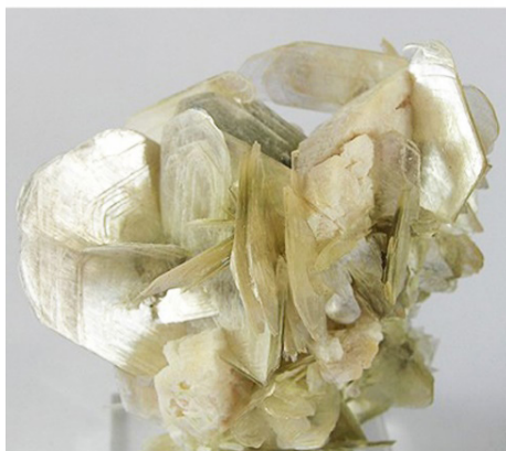
شکل ۱. تصویر و ساختار کریستالی ذرات معدنی مسکوویت [۲]
