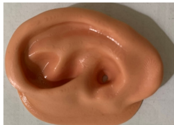
شکل ۲. نمونه پرینت شده از گوش انسان با هیدروژل الاستومری EPUH-80
