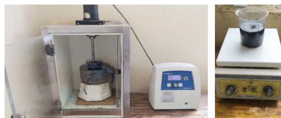
شکل ۲. (الف) مخلوط رزین و نانو لوله کربنی بر روی هیتر استیرر (ب) و همگن‌سازی رزین با فرآیند هم زدن فراصوت
