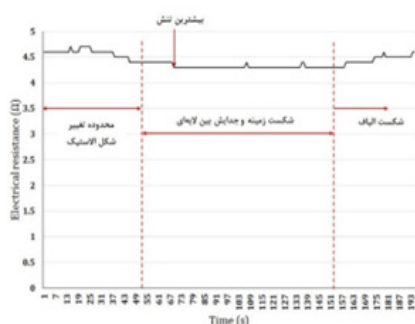
شکل ۱۰. تغییرات مقاومت الکتریکی برای تیر بدون عیب در حین بارگذاری خمشی
