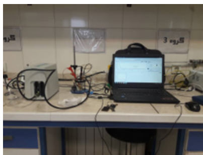
شکل ۳. ستاپ آزمون خوردگی تافل و کروئوامپرومتری.
