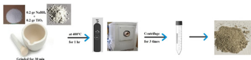
شکل ۲. فرایند احیا تیتانیوم دی اکسید توسط سدیم بروهیدرید و گاز آرگون.
