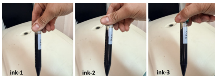
شکل ۵. پایداری کلوئیدی جوهرها پس از سانتریفیوژ (سرعت چرخشی ۸۰۰۰ دور در دقیقه برای ۱۵ دقیقه).
