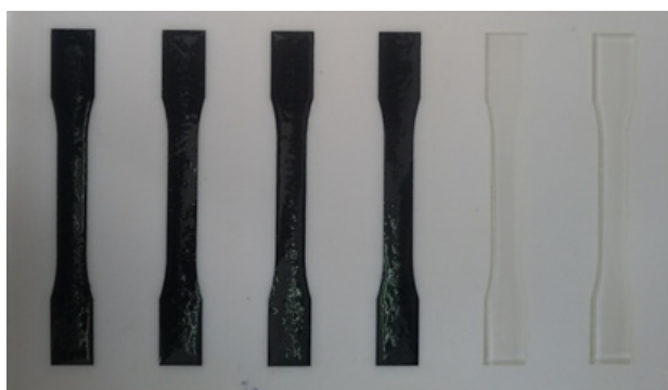
شکل ۱) قالب سیلیکونی و نمونه‌های کشش با استاندارد ASTM D6۳۸
